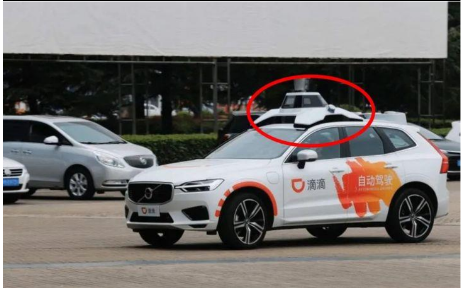
图 12：滴滴无人车顶配备了 Velodyne 的 64 线激光雷达
