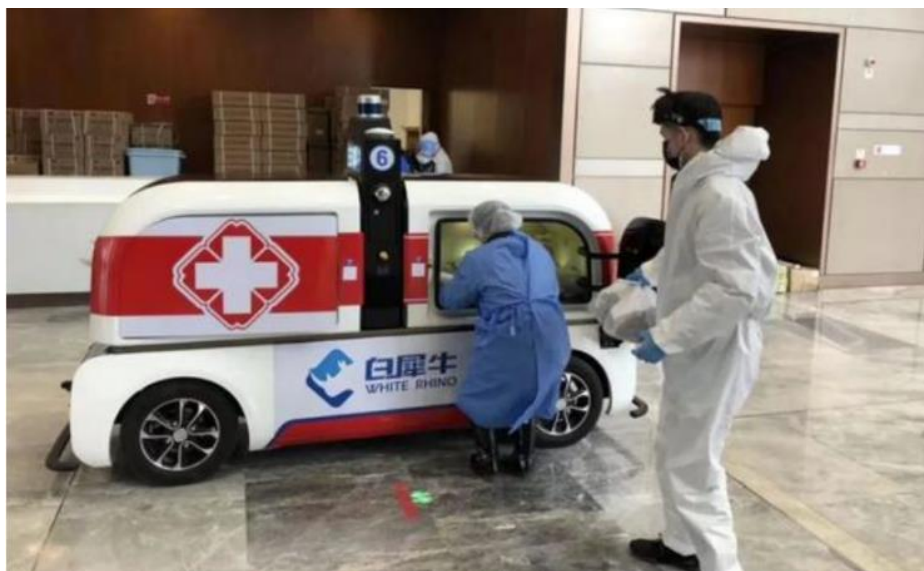
图表19 搭载有激光雷达的无接触配医用物资配送小车
