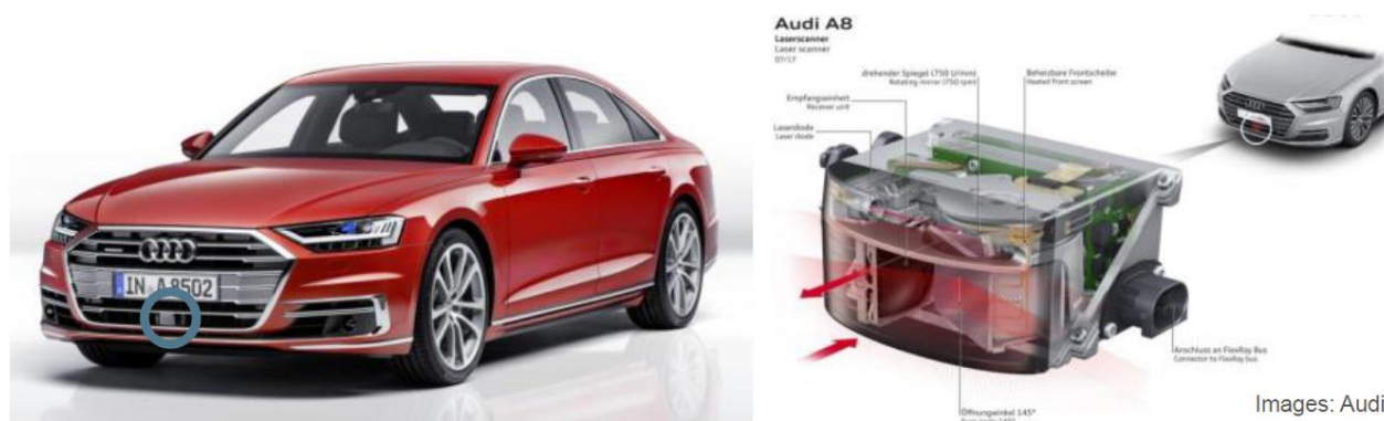
图表18 Audi A8 搭载 Valeo 激光雷达
