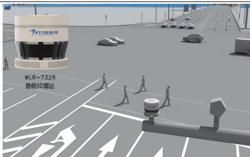
图表35 用于车路协同的WLR-732路侧32线激光雷达
