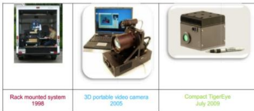
图 19: Flash 激光雷达小型化历程
