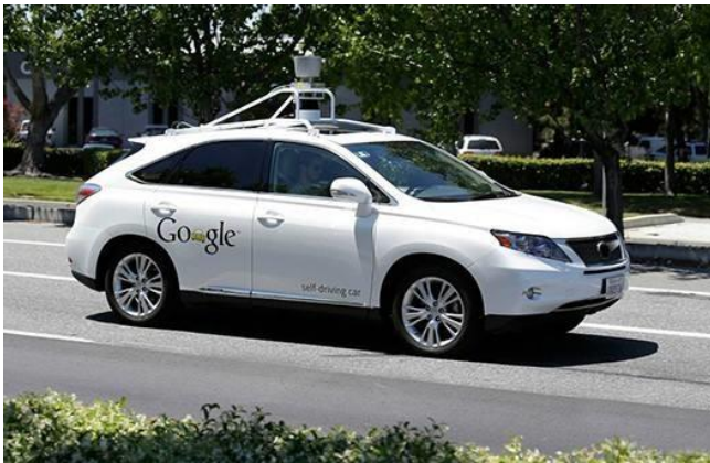
图 9：搭载 Velodyne 的自动驾驶测试车
