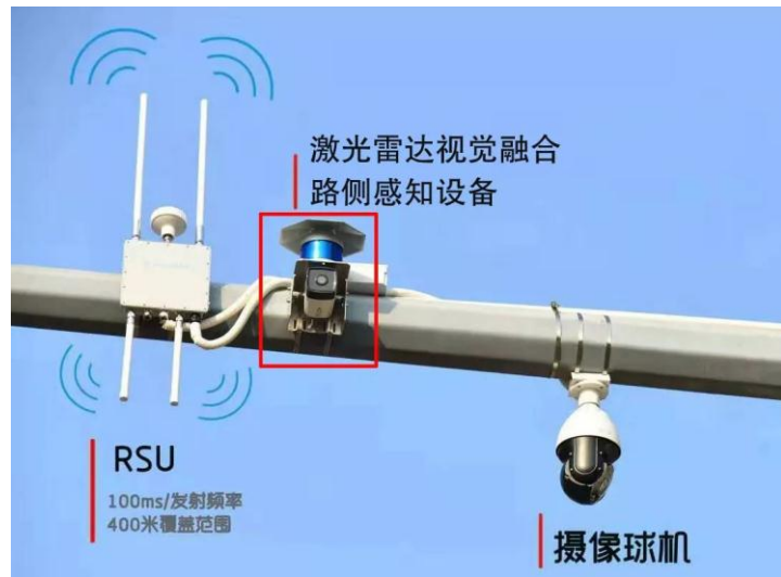
图 4.激光雷达在路端补充摄像头的感知不足
