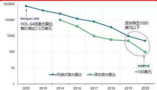
图 3 2017-2020 年机械式/固态式激光雷达成本及预测
