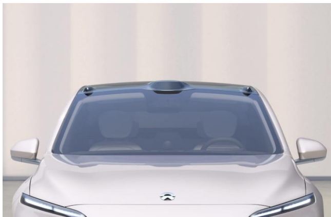
图 1：蔚来 ET7 车顶传感器
