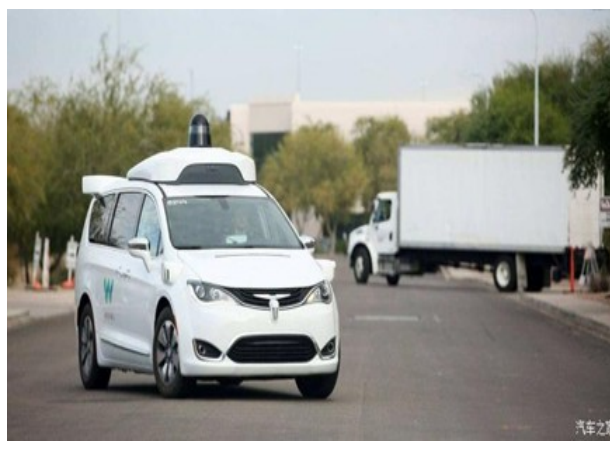
图 10. Waymo 无人车采用机械式激光雷达
