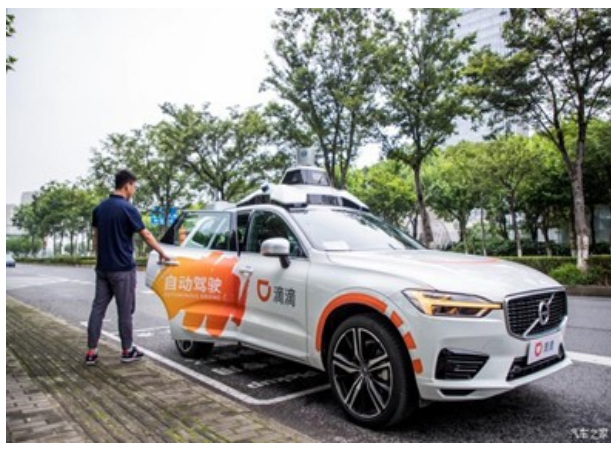
图 9. 滴滴无人车采用机械式激光雷达
