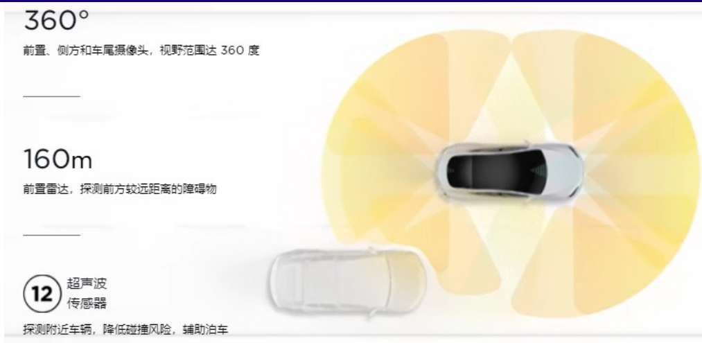
图 7. 特斯拉 Model Y 的视觉方案
