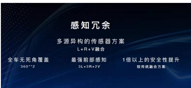
图10 长城咖啡智驾实现感知冗余——多源异构传感器方案
