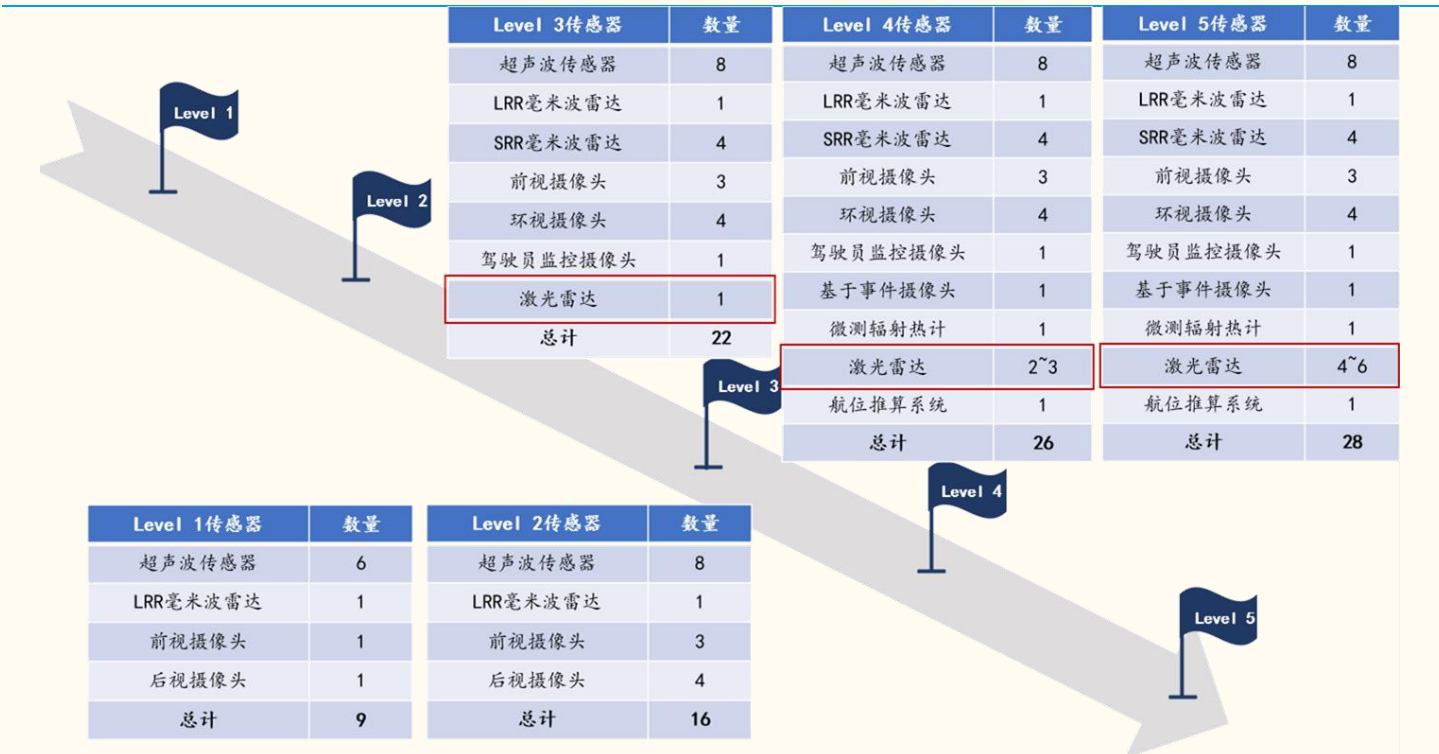
图表 5：随着自动驾驶级别提高，激光雷达配备数量需求增加
