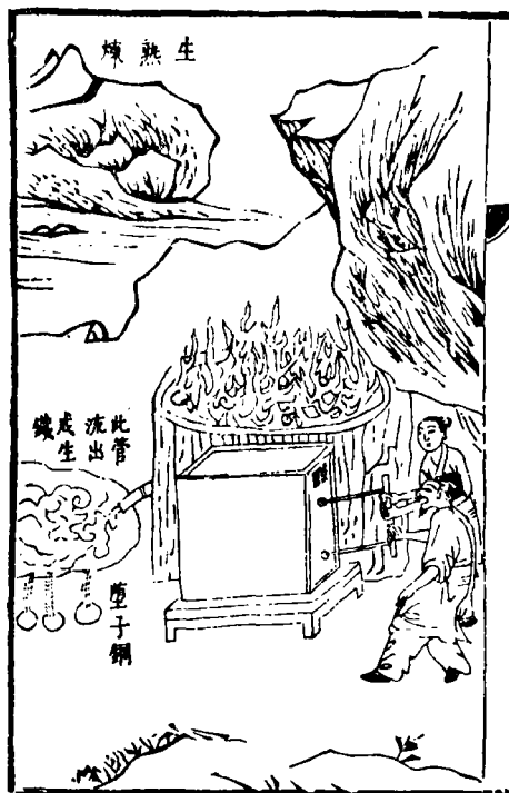
图一一 宋应星《天工开物》炼铁图中的风箱
